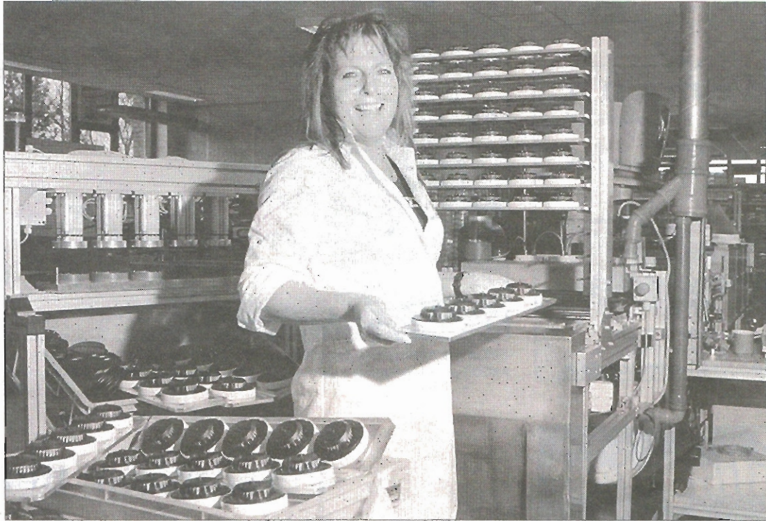
Gabriela Christiansen (45) gibt an der Einstellstraße elektronisch die Rauchdichte ein, bei der die Warnmelder Alarm geben. Die Monteurin ist seit sechs Jahren bei Detectomat.
